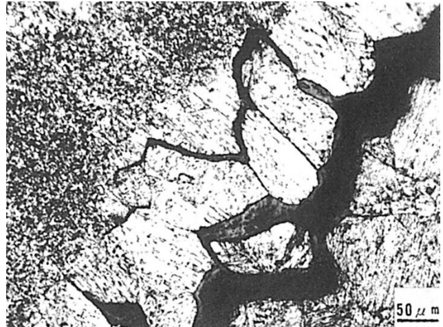
Fig.3 HT-80 の熱影響部粗粒域に発生した SR 割れのマイクロ組織 (斜め Y 形自拘束試験片による SR 割れ試験片, 600℃×2hr 空冷)
