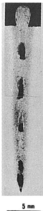
Fig.2 溶接部横断面マクロ
