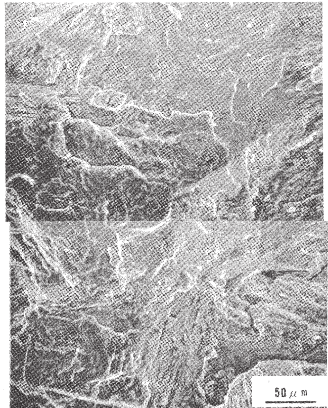
Fig. 5 ルート部以外の破面の一例
