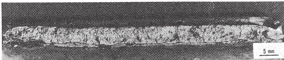
Fig. 1 ルート割れ 破面の全景
