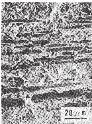
Fig.5 高張力鋼の拘束窓形溶接割れ試験で再現されたラメラテアのミクロ破面(伊藤,池田,小西,小溝) 6)
