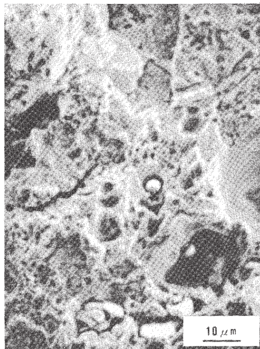
Fig. 4 割れのルート部近傍のマイクロ破面（球状の介在物、スケール）
