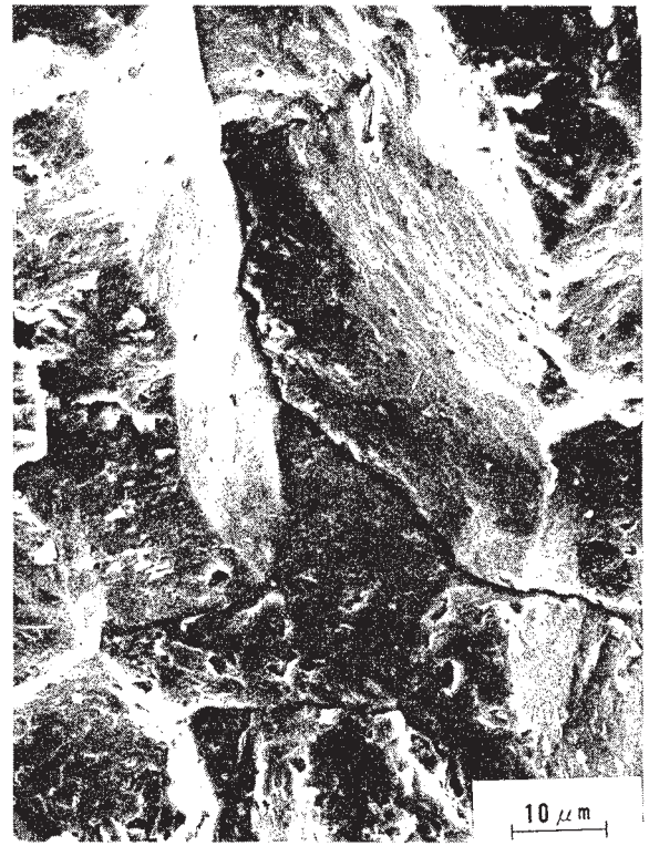
Fig. 4 水素粒界破面（ビード中央部）
