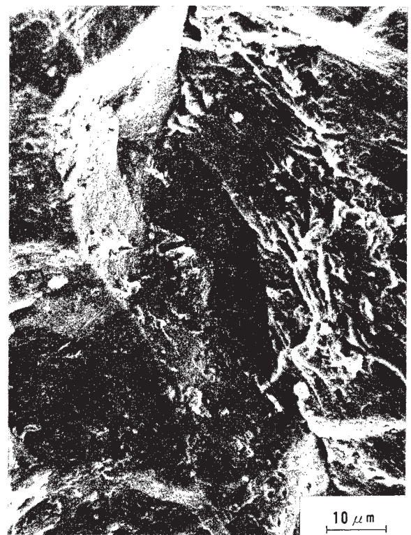
Fig. 6 水素粒界破面と部分的に水素擬へき開破面が認められる。（ビード表面近傍）
