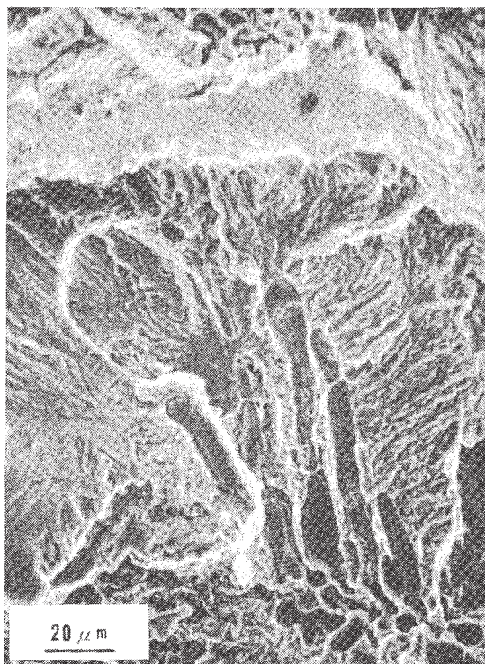
Fig. 5 ラメラテア状の割れのマイクロ破面
