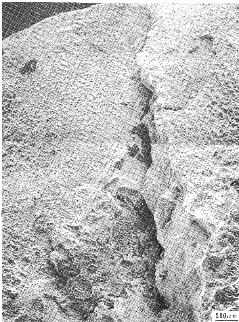
Fig. 3 割れ部の断面マクロ写真
