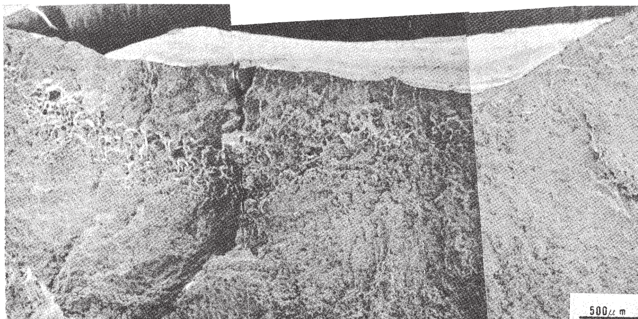
Fig. 4 仮付けビード端から生じた割れ破面の低倍率のミクロ破面
